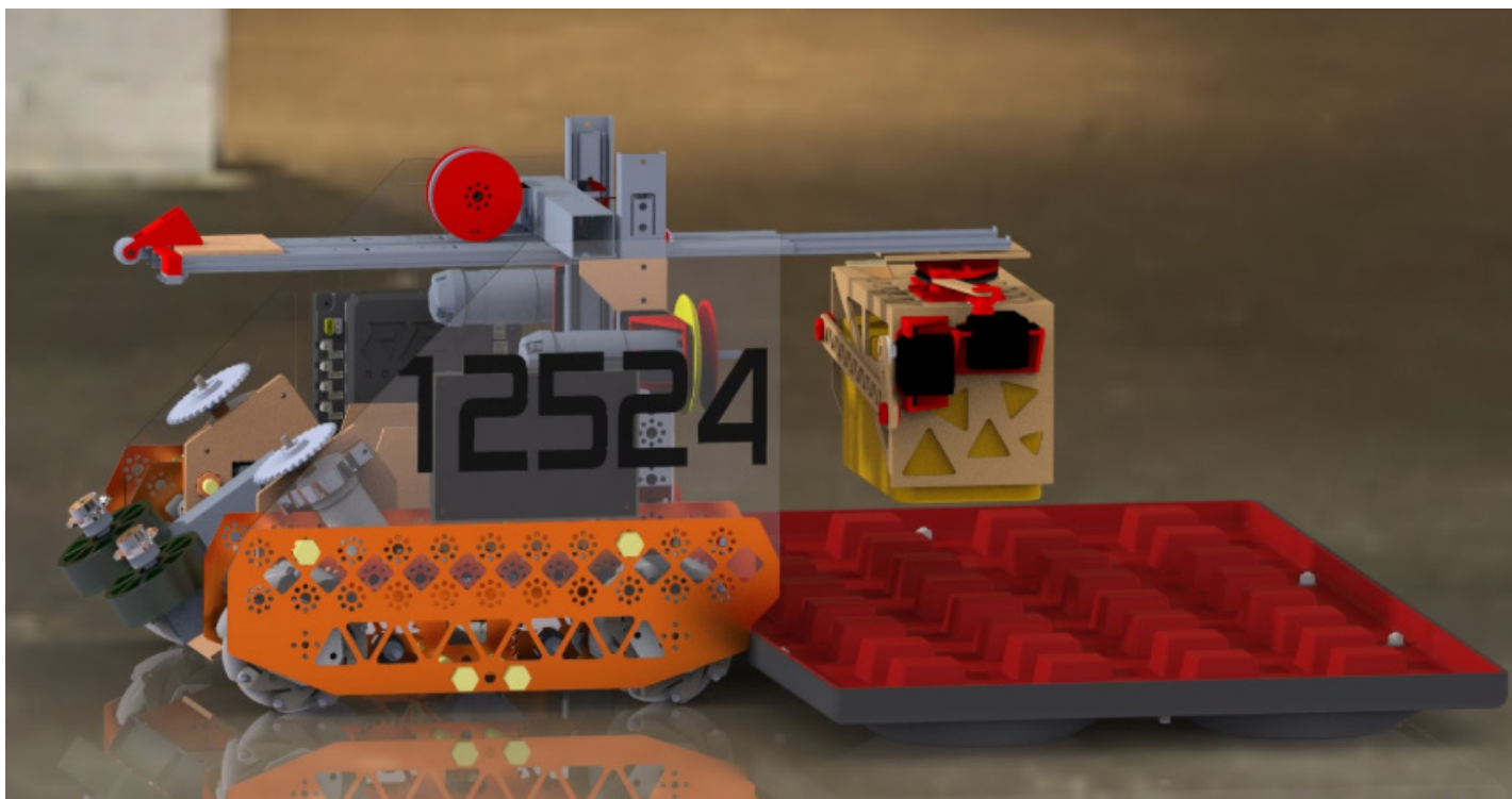
Вторая версия манипулятора в положении строительства (декабрь 2019)
