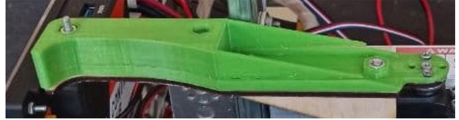
Мы решили сделать крюки не из фанеры, а из пластика и сделать их толще, рассчитывая, что увеличение площади обхвата сделает захват более надежным. В этой версии воббл сильно давил на один из крюков, раздвигал их и выскальзывал.
