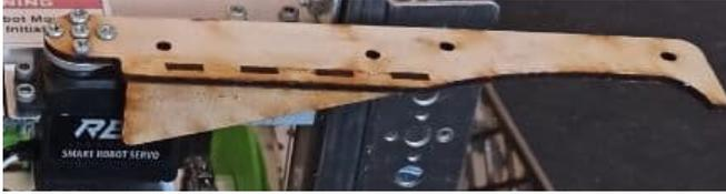
Изначально захват представлял собой два простых фанерных крюка. Из-за достаточно большой длины крюков они достаточно сильно отклонялись вверх-вниз. И из-за этого при резком движении воббл выпадал из захвата.
