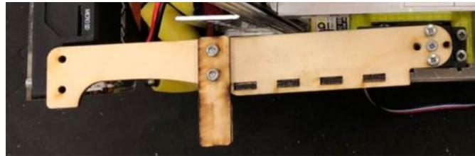
Эта версия хорошо показала себя в тестах, поэтому мы доработали ее и сделали более элегантной. Таким образом финальная версия захвата воббл представляет собой два фанерных крюка с упорами. Этот механизм позволяет захватить воббл в любом месте поля, включая самый угол, и быстро двигаться с ним.
